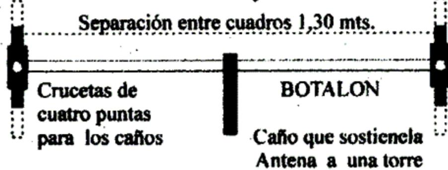
El caño utilizado como BOTALON es levemente superior al metro treinta de largo, que es la separación entre los 2 cuadros (Irradiante y Reflector). Diámetro interno 32 mm. Espesor 3 mm.
