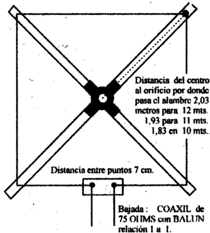
La plaqueta para el cable de bajada debe ser de material aislante y tener 12 cm. de largo, por 4 cm. de alto y un espesor adecuado.
